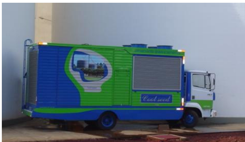
Figura 2 - Equipamento de refrigeração artificial do ar ambiente, utilizado para resfriamento da massa de grãos de trigo, Palotina-PR, 2003.
